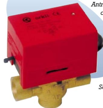
Ein Nocken ermöglicht den manuellen Antrieb des Ventils bei Unterbrechung der Spannungsversorgung, sowie zum Füllen, Lüften oder Entleeren der Anlage. Kommt es aus irgendeinem Grund zu einer Unterbrechung der Stromversorgung, so wechselt das Ventil selbständig in die Schließstellung zurück.
